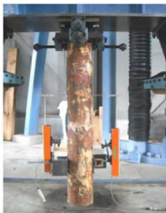
写真：継いだ木材の圧縮試験
