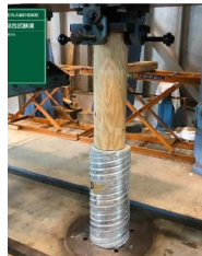
写真：木材とコンクリート柱体の圧縮試験
