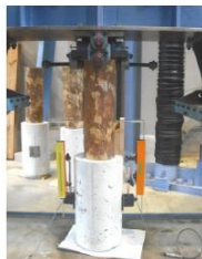
写真：木材とコンクリート柱体の圧縮試験
