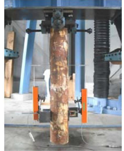
写真：通し丸太の圧縮試験
