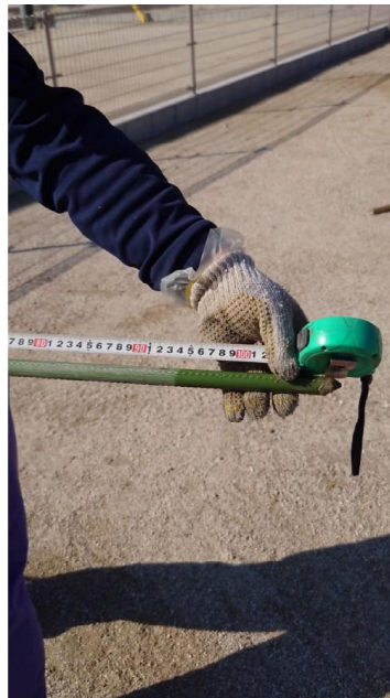
動画：SWS試験孔での水位確認状況
